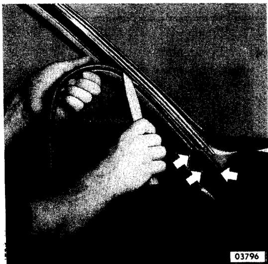
Poser un profilé d'étanchéité neuf, enfoncer son extrémité plate dans le montant central et le fixer avec l'agrafe de retenue.
