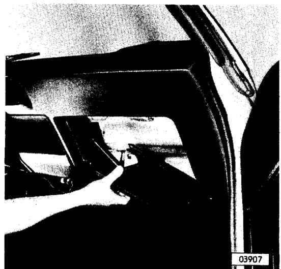
Avant d'effectuer la repose, appliquer de la pâte d'étanchéité réf. 15 70 586 entre le boîtier du répartiteur d'air et le tablier.
