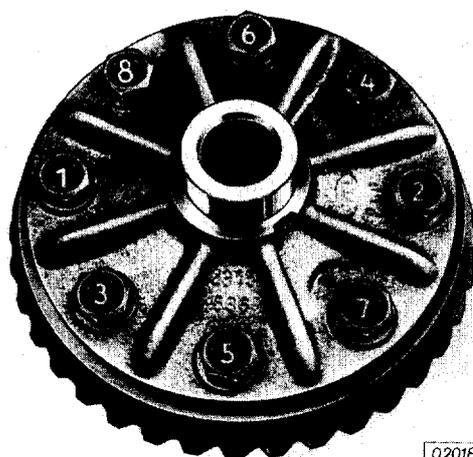
Contrôler le voile de la couronne montée dans des cales en V. Le voile maximum admissible est de 0,08 mm. Utiliser le comparateur avec son élément d'adaptation (A).
